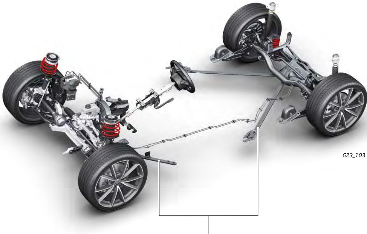
Les traverses d'essieux du train avant et du train arrière sont reliées à la carrosserie par des barres stabilisatrices supplémentaires. Cet appui sert à la réalisation d'une rigidité élevée du véhicule et d'un confort vibratoire élevé.
