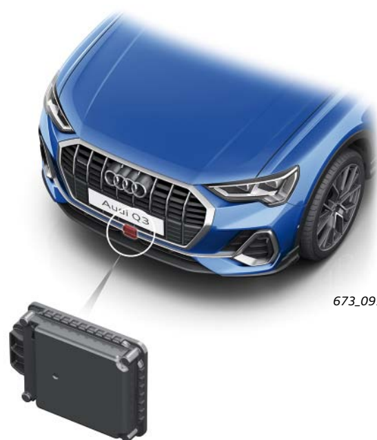
Transmetteur droit de régulateur de distance G259 et calculateur de régulateur de distance J428
